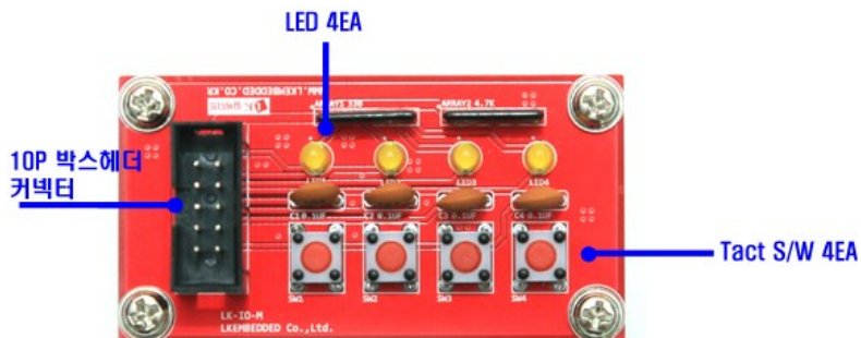
<그림 1.2> IO(입출력: LED, S/W)모듈 구성
